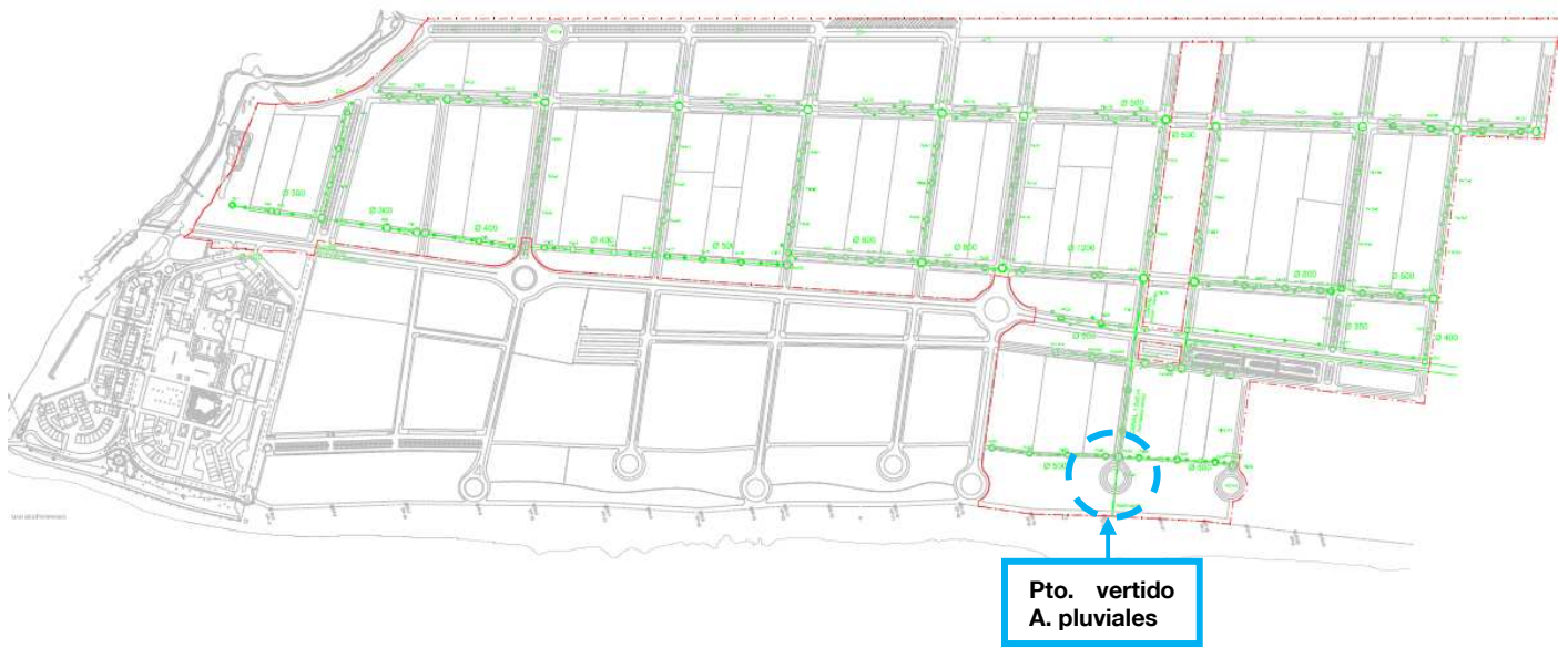
Red separativa de aguas pluviales de la urbanización Marina d'Or (sector 5A) y detalle del punto de vertido a mar
