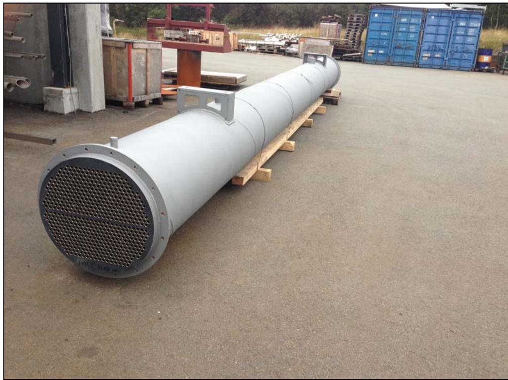
Imagen del interior de un condensador de multitubular de titanio + acero + HDPE
