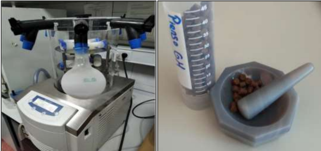
Figura 5: Liofilitzador per a mostres de C. nodosa (esq.) i morter de àgata per a la polvorització de les mostres destinades a l'anàlisi d'isòtops estables (dta.)
