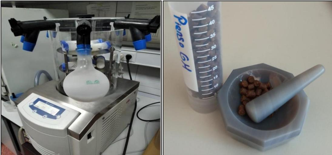
*Figura 5: Liofilizador para muestras de *C. nodosa* (izda.) y mortero de ágata para la polvORIZACIÓN de las muestras destinadas al análisis de isótopos estables (dcha.)*
