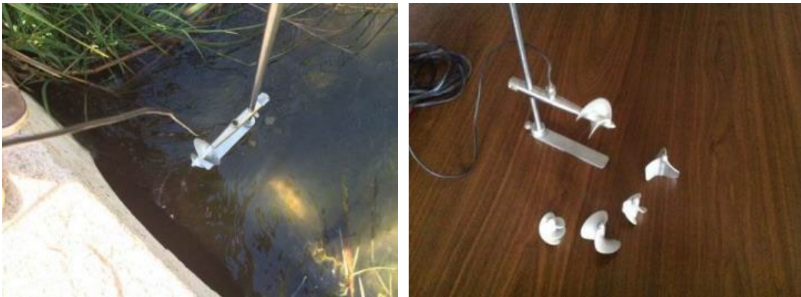
Figura 10. Imatges de molinet per a mesurament de velocitat del flux emprat en el projecte.
