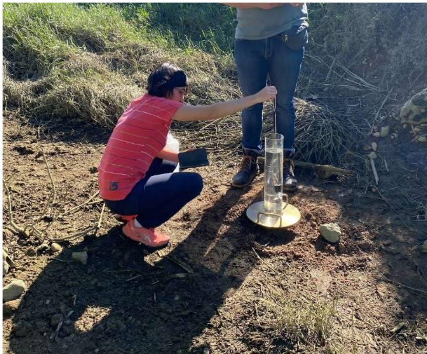
Figura 8. Mesura de la permeabilitat en el Bnc. de Picassent.
