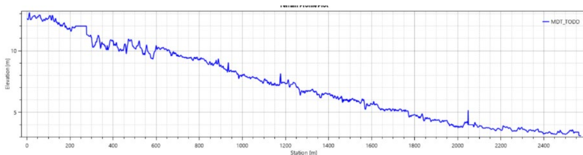
Figura 5. Perfil longitudinal del Bnc. de Picassent des de la confluència amb el Bnc. del Realó fins al pas sota la V-31.
