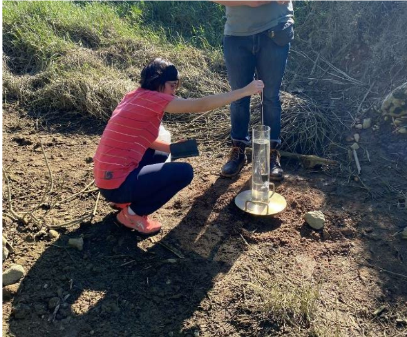
Figura 8. Medición de la permeabilidad en el Bco. de Picassent.
