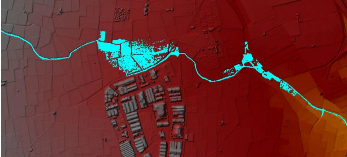
Figura 32. Extensión de la lámina de inundación en el entorno del polígono industrial El Pla.
