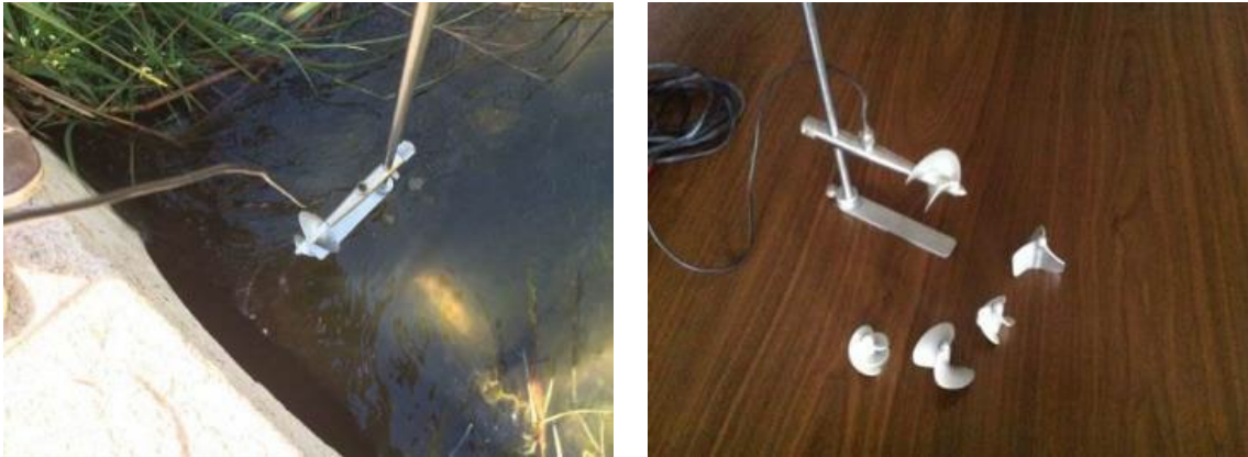
Figura 10. Imágenes de molinete para medición de velocidad del flujo empleado en el proyecto.
