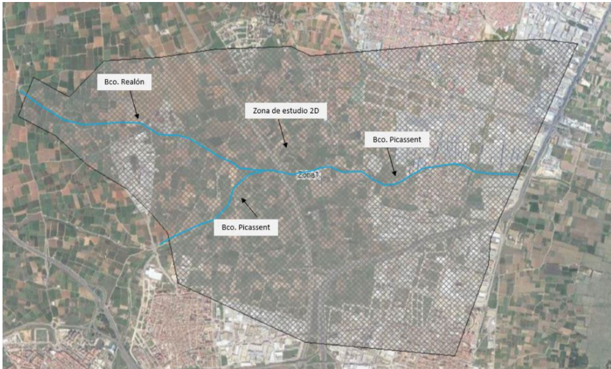
Figura 20. Extensión de la malla de cálculo 2D del modelo hidráulico para altos periodos de retorno.
