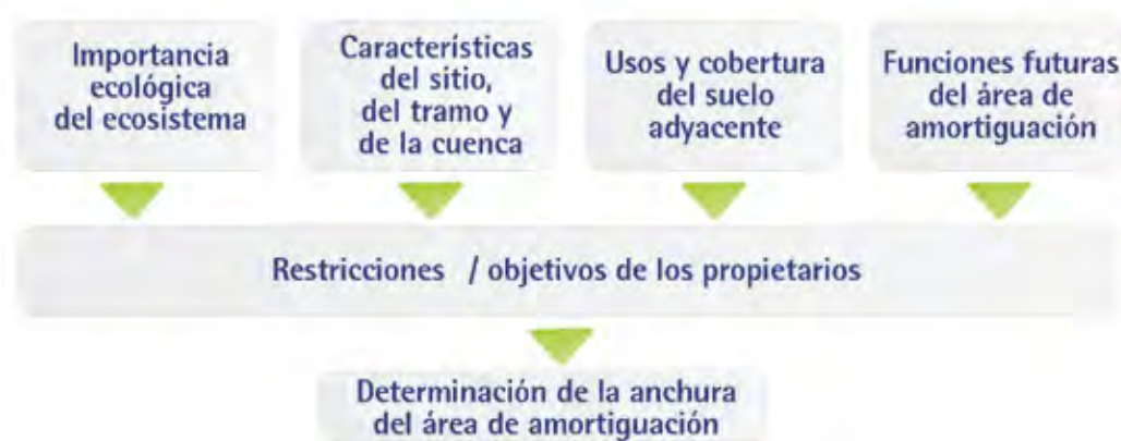
Figura 4.8.1 Criterios para determinar la anchura del área de amortiguación fluvial (adaptado de Palone y Todd, 1998).
