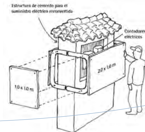
Figura 5.3.4 Panel interpretativo creado para cubrir estéticamente un contador eléctrico al lado de la Iglesia de Agios Varnavas.
