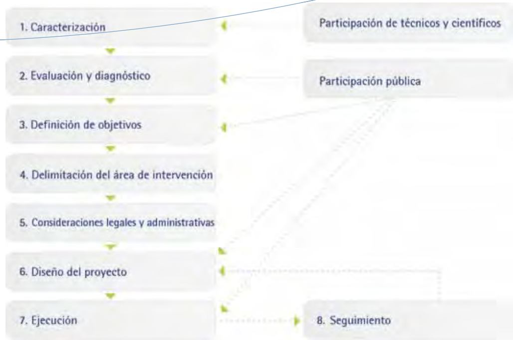
Figura 4.1.1 Diagrama de flujo de las fases de un proyecto de restauración en un sistema fluvial.
