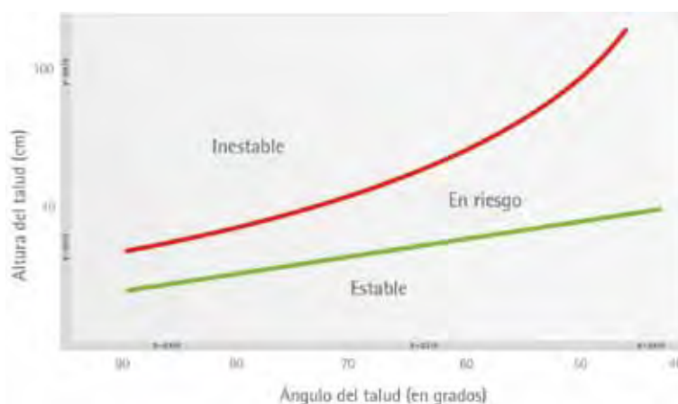
Figura 1.3.3 En esta gráfica se aprecian las relaciones entre la estabilidad del talud y la altura y la inclinación del mismo (solamente indicada para suelos saturados). La altura se expresa en escala logarítmica (adaptado de Kondolf y Piégay, 2005).
