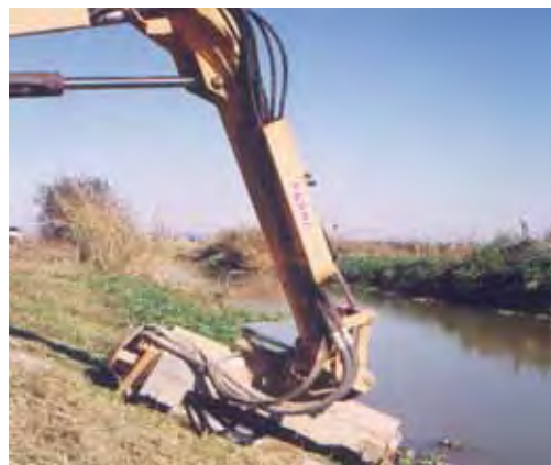
Figura 4.6.4 Limpieza de un margen usando una cabezal triturador (foto: Ilídio Moreira).
