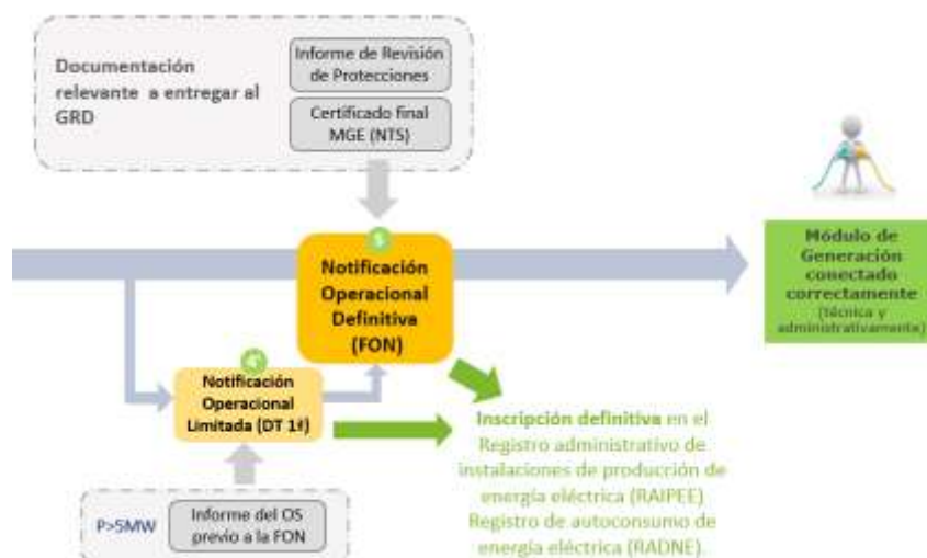
FIGURA 12. Puesta en servicio de los MGE Tipo A (<=100 kW) conectados a la RdD del SEPE
