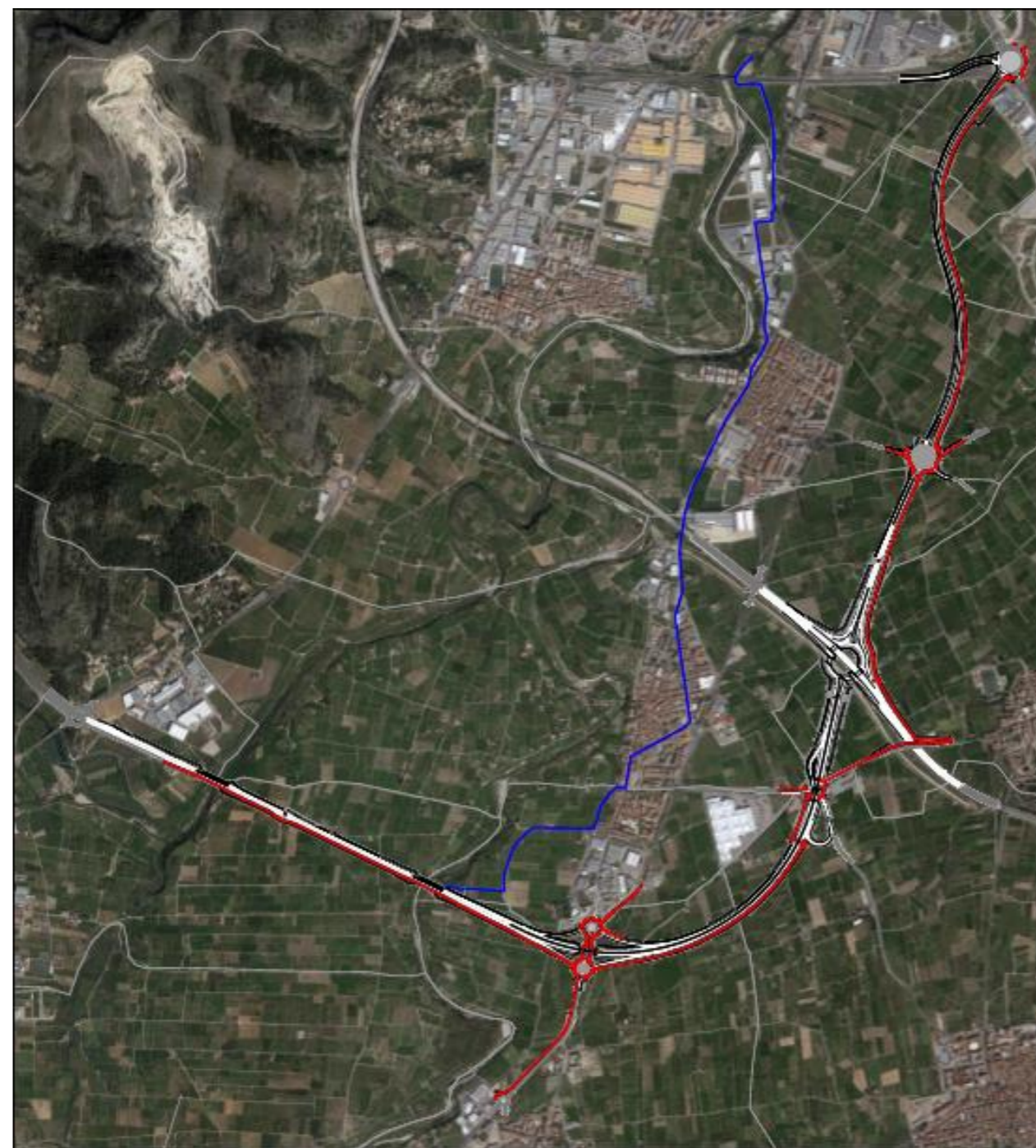
Figura 9: Alternativas del carril ciclopeatonal sobre planta de trazado de la CV-60. Fuente: Elaboración Propia.
