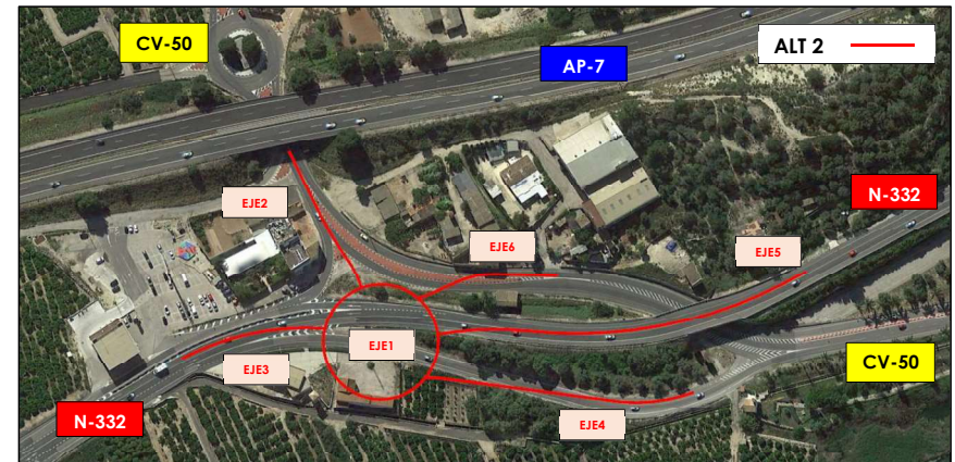
Imagen 6. PLANTA SOBRE ORTOFOTO DE LA ALTERNATIVA 2 DE CONEXIÓN CON LA N-332.
