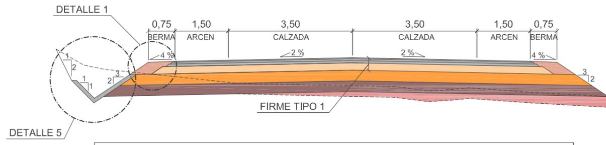
SECCION TIPO TRONCO PRINCIPAL. RECTA EN NUEVO TRAZADO
