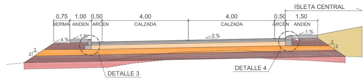
SECCION TIPO EN ROTONDAS
