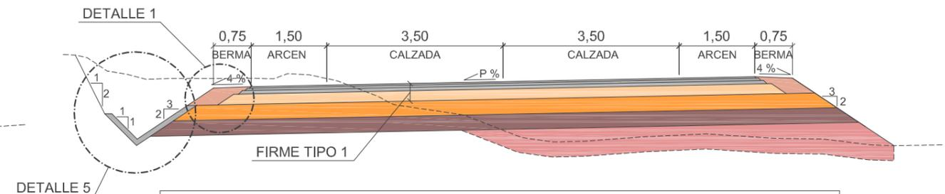
SECCION TIPO TRONCO PRINCIPAL. CURVA EN NUEVO TRAZADO
