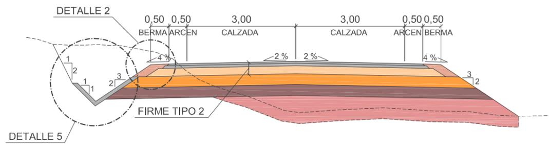
SECCION TIPO VIA DE SERVICIO BIDIRECCIONAL
