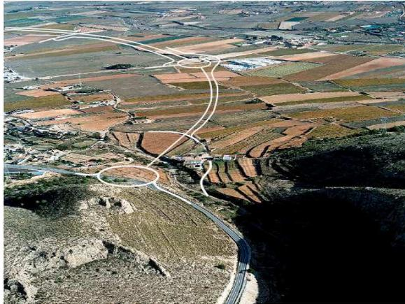
**Tramo 4: La Romana – Ronda Suroeste de Novelda:** tiene 7.636 metros de longitud y 6 rotondas. Se divide en dos tramos, el primero, La Romana – Novelda, tiene 6.300 m y 4 rotondas. De la rotonda 4 salen dos ramales para conectar la carretera CV-835 hacia Monóvar con la Ronda Sureste de Novelda. Este segundo tramo, denominado Ronda Suroeste de Novelda, tiene dos rotondas más y 1.336 metros de longitud.
