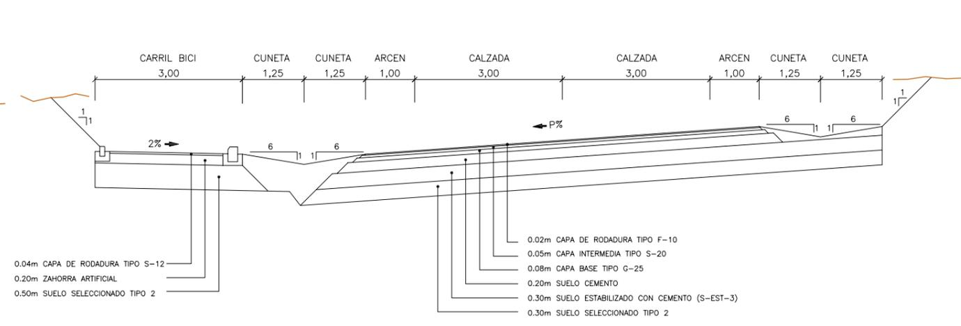
SECCIÓN TIPO TRONCO EN DESMONTE. TRAMO CURVO
