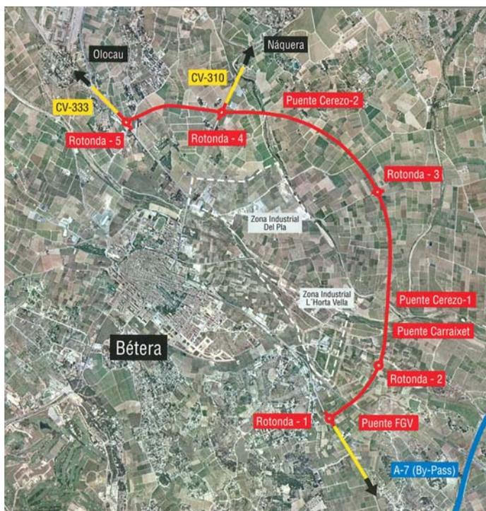
El trazado de la Variante Norte de Bétera tiene una **longitud aproximada de 5.600 m**, a lo largo de los cuales se localizan 5 glorietas que, junto a las vías de servicio laterales, proporcionan el **control total de accesos** a la carretera.
