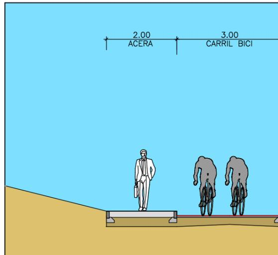
SECCIÓN TIPO (FIRME: SECCIÓN 3122)
