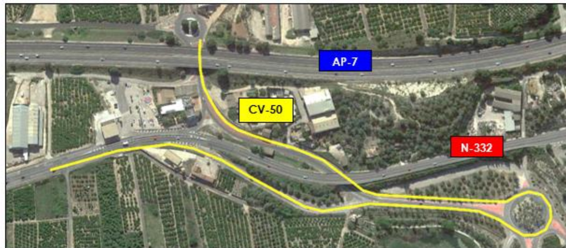
Imagen 27. Conexión actual de la N-332 en sentido norte con la CV-50.
