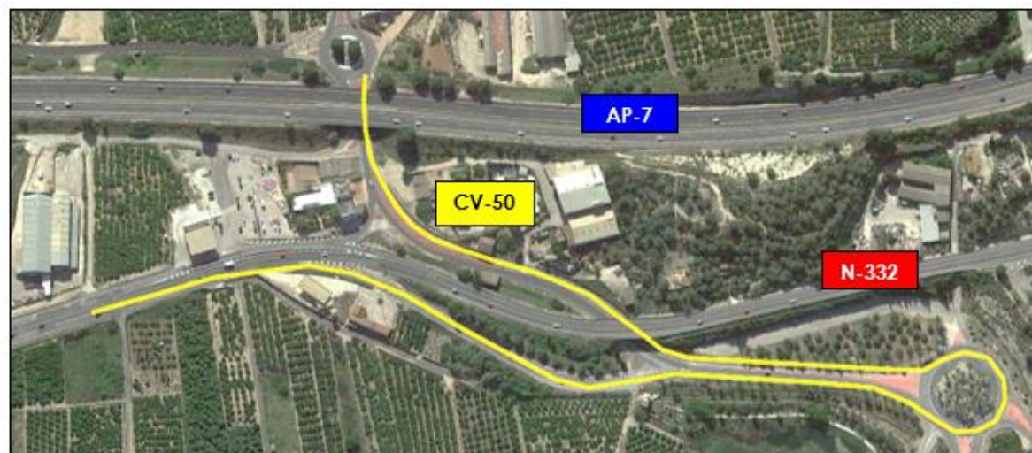
Imagen 65. Conexión actual de la N-332 en sentido norte con la CV-50.
