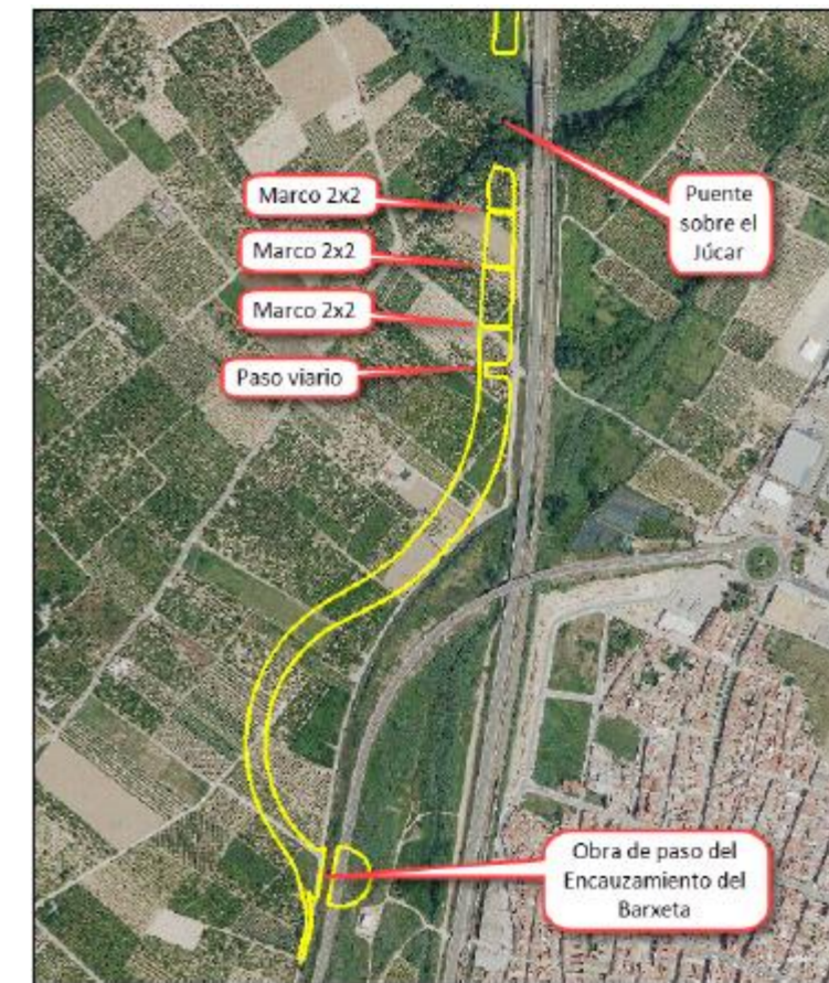
Figura 35. Obras de drenaje transversal previstas. Tramo Sur
