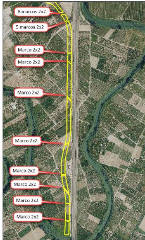
Figura 34. Obras de drenaje transversal previstas. Tramo Centro
