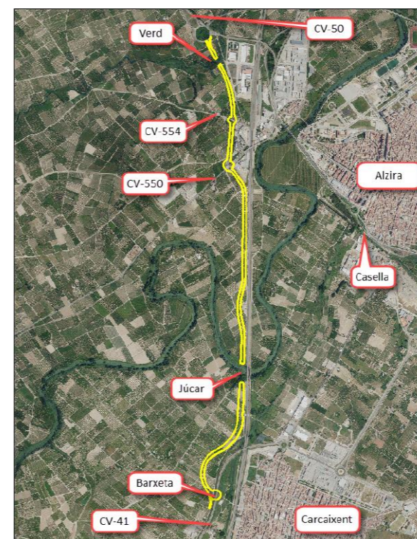
Figura 1. Trazado de la carretera-Cuencas interceptadas
