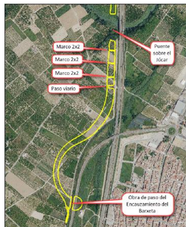
Figura 4. Obras de drenaje transversal previstas. Tramo Sur
