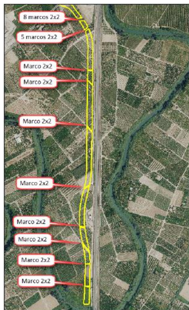
Figura 3. Obras de drenaje transversal previstas. Tramo Centro
