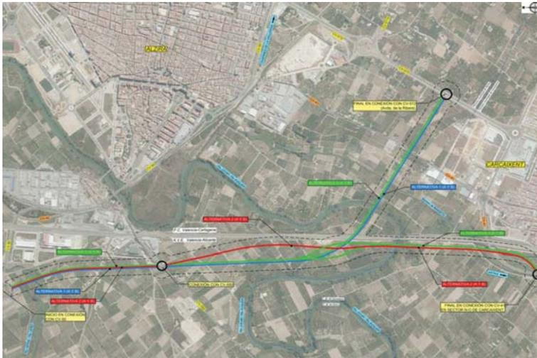
Se han planteado 4 alternativas diferentes: alternativa 0, 1, 2 y 3. Para las alternativas 1, 2 y 3 se plantean a la vez dos soluciones: A, con la rasante a cota del terreno natural y, B, con la rasante sobreelevada. Con las soluciones "B" se busca que la
