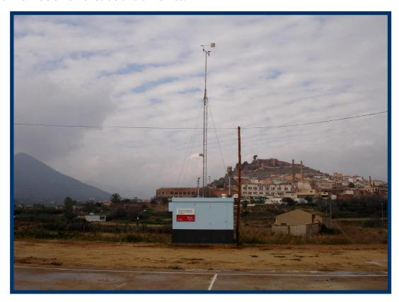
La Red Valenciana de Vigilancia y Control de la Contaminación Atmosférica, a través de las diferentes estaciones que la componen, realiza mediciones en continuo de diferentes parámetros contaminantes como el dióxido de azufre (SO<sub>2</sub>), partículas en suspensión con diámetro inferior a 10, 2.5 y 1 micras (PM10, PM2.5, PM1), dióxido de nitrógeno (NO<sub>2</sub>), monóxido de carbono (CO), plomo (Pb), hidrocarburos, sulfuro de hidrógeno (SH<sub>2</sub>) y ozono (O<sub>3</sub>).
