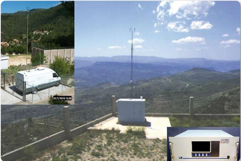
La medición de la concentración de ozono en el aire se puede efectuar mediante diferentes técnicas e instrumental; no obstante, su medida se encuentra normalizada, realizándose mediante equipos electrónicos (monitores automáticos de absorción ultravioleta), que forman parte de las infraestructuras de las redes de vigilancia de la calidad del aire, constituidas por cabinas donde se integran medidores de otros contaminantes junto a instrumentación meteorológica.
