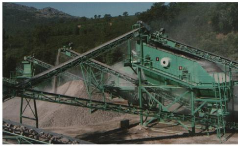
La criba ZB produce la vibración por el sistema de contrapeso Lo que permite aumentar y disminuir la amplitud de vibración con aumentar o disminuir estos, elevando considerablemente el rendimiento .
