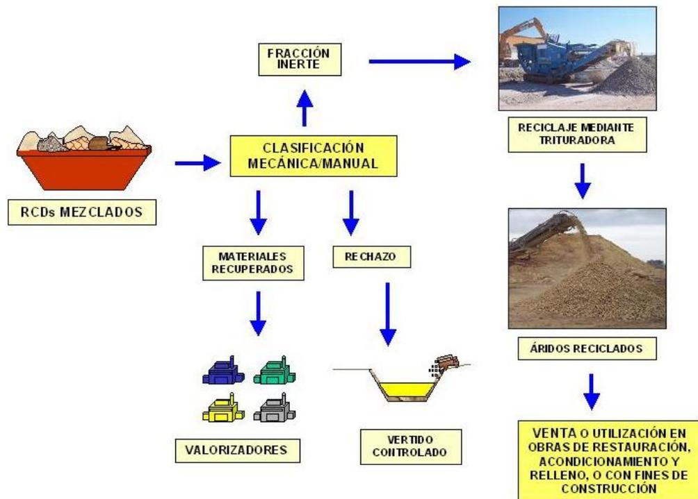
Figura 14. Flujo de los RCDs mezclados
