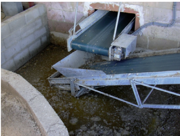
Figura 8. Salida de la nave de las cintas transportadoras de retirada de la gallinaza. Fuente: Fotografía propia.
