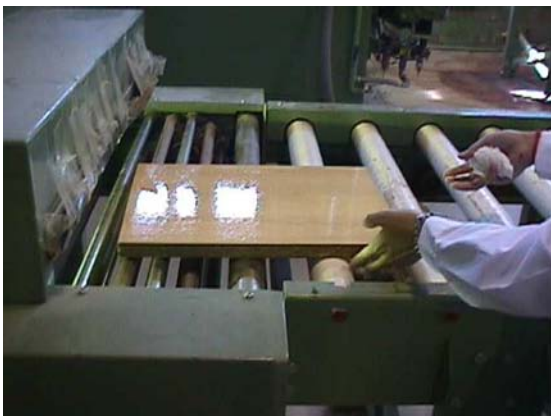
Túnel de secado UV. Fuente AIDIMA.
