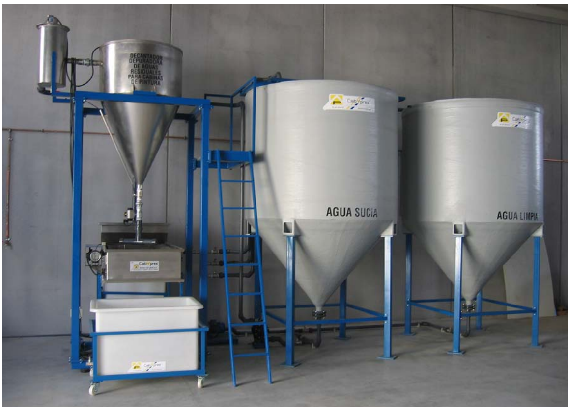
Elementos básicos del sistema de depuración del agua de las cabinas-1. Fotografía cortesía de TECNOAIRPINT.
