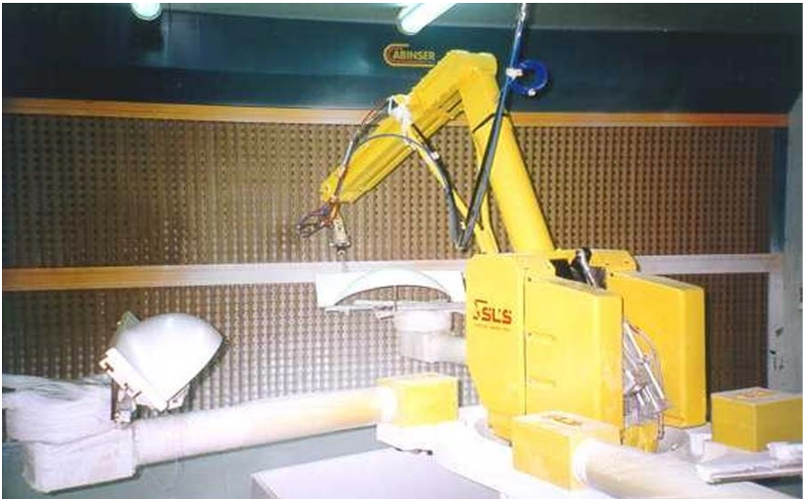
Robot Pulimento. Fuente: AIDIMA
