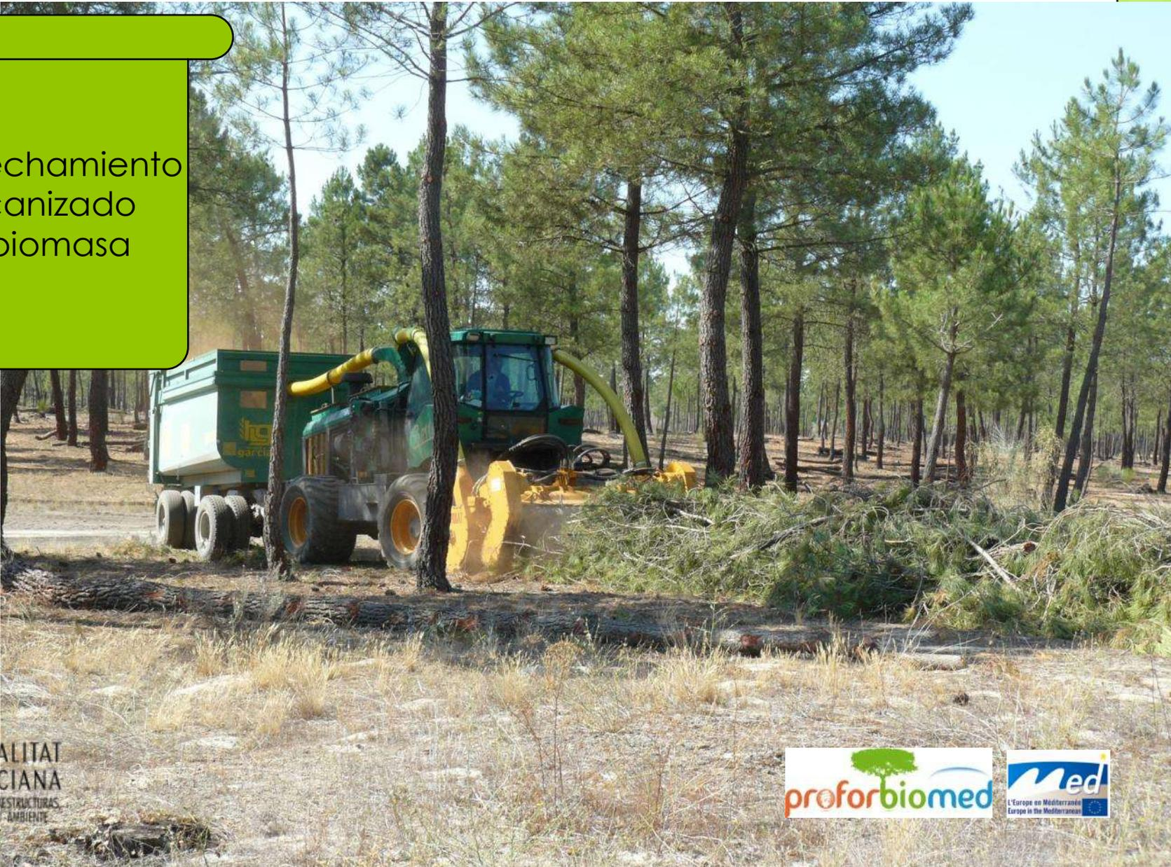
Mecanización total de la obtención de biomasa: Máquina cosechadora de biomasa en las llanuras de Castilla, zona de los pinares Duero de Coca.
