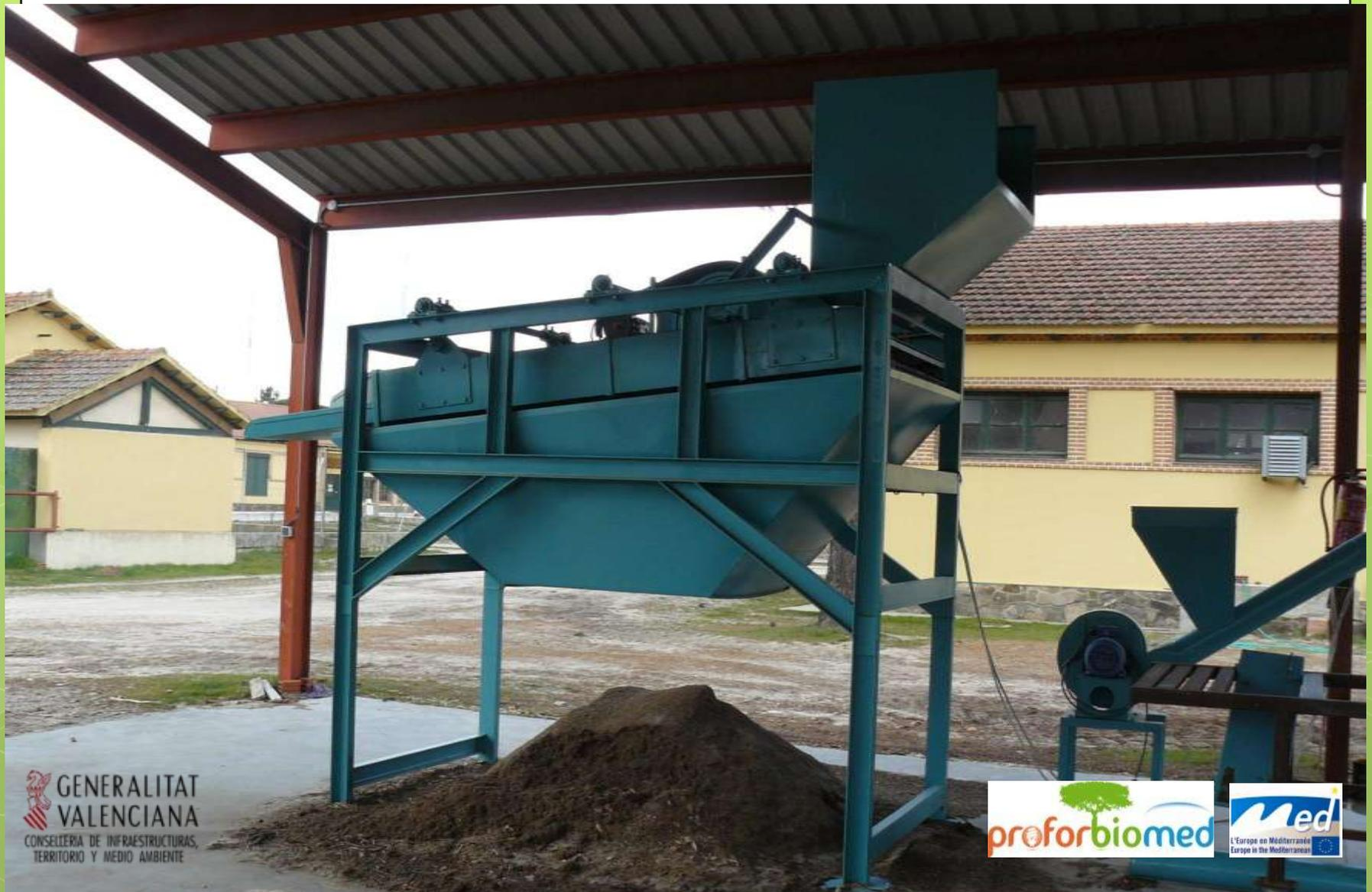
La astilla recogida de las capas más inferiores de la cama, se criba para retirar las arenas y finos que eviten paradas en los sistemas.
