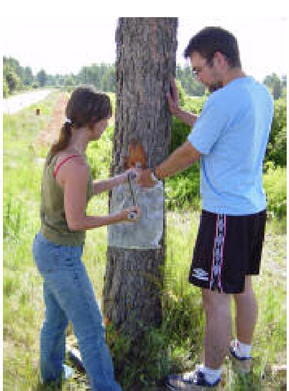
FOTO 1: Proceso de toma de muestra en el que se observa el manejo de la barrena y la bolsa donde se recoge la viruta.
