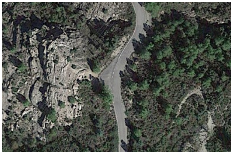
Figura 13. Apartaderos en caminos con ancho reducido situados en puntos con visibilidad. Tramo Bejís-Arteas de Abajo [Castellón]. Fuente: Google maps.
