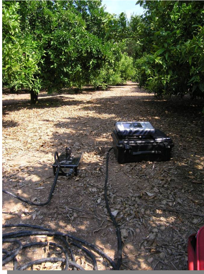
Figura 12. Fotografía donde se muestra la medición realizada en la 4ª fila de naranjos con la antena de 900 MHz.
