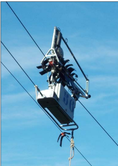
Mecanismo utilizado para la colocación de salvapájaros en la línea de la Poble de Benifassà-Bel. Autor: Electra del Maestrazgo.
