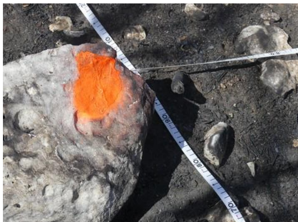
Imágenes 7 y 8: Replanteo de las parcelas de seguimiento. Marcaje del centro de la parcela con spray (izquierda) y delimitación de la superficie de la parcela mediante cintas métricas (derecha). Fotografías: Ciro Pascual y Ramón G. Pereira.
