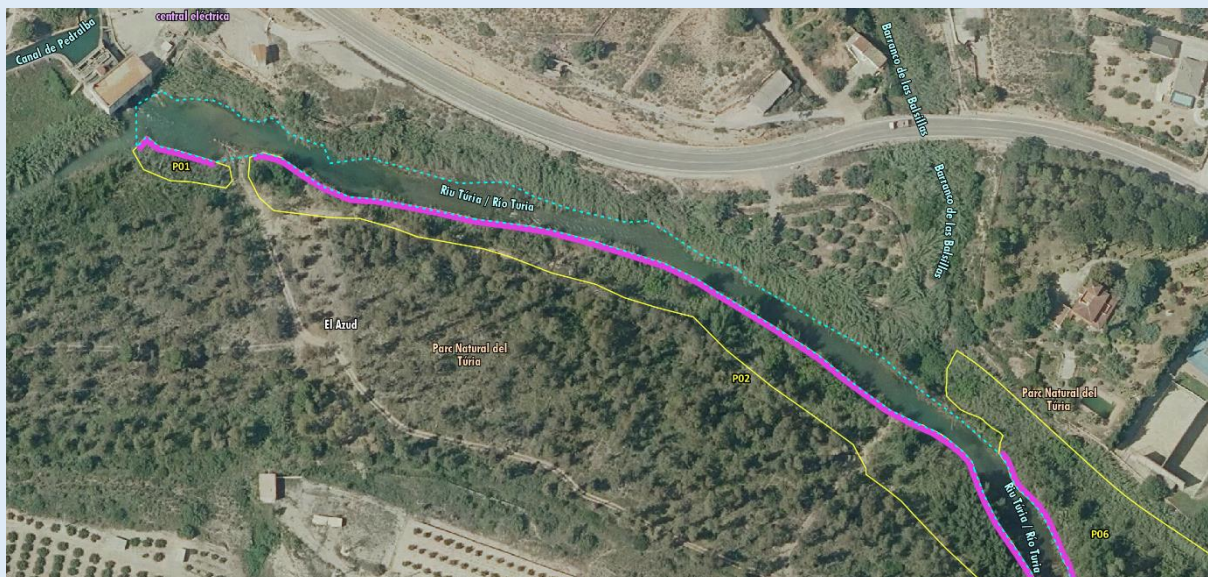
Imagen 6: Lámina de agua (línea punteada azul), rodales de eliminación de cañaveral (polígonos amarillos) y áreas de extracción de rizoma (superficies en rosa). Fuente: Elaboración propia mediante SIG a partir de ortoimagen PNOA.
