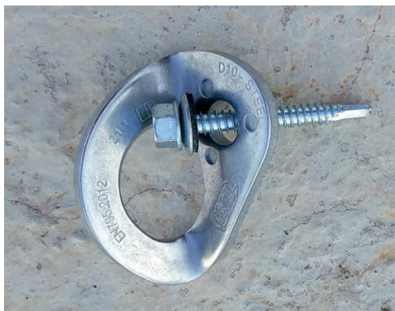
Chapa anclaje tipo PETZL con tornillo autotaladrante de 8mm de espesor, 60 mm de longitud y cabeza hexagonal
