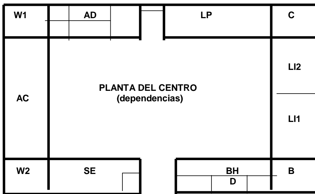
Figura 9. Distribución de las dependencias del CIMAR: (AC) aula de conferencias; (AD) área de descanso; (B) Buceo; (BH) biblioteca-hemeroteca; (C) almacén de colecciones y material; (D) despachos; (SE) sala de exposiciones; (LI) laboratorios de investigación; (LP) laboratorio de prácticas; (W) aseos .
