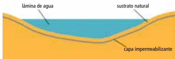
Esquema de colocación de la capa impermeabilizante.
